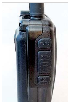
Bild 4: Griff gummiert liegt die großzügig dimensionierte Sendetaste zwischen der Zweitfunktions- und der Monitortaste.
