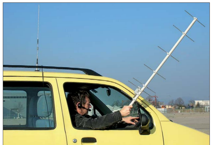
Bild 1: Die Siebenelement-Leichtbauagi nach DK7ZB [8] bewährt sich hier im Downlink von FO-29. Auf dem Wagendach befindet sich eine SG-M507 von Diamond für den Uplink.
