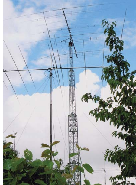
Beamantennen: vorn JP-2000, Mitte OPTI 18-6, hinten Fritzel-Beam und darüber ein Element für 40 m
