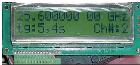
Bild 3: Für Kanal 2 wurde der Messwert (hier 200 MHz) mit 128 multipliziert. Die letzte Stelle entspricht 10 Hz und ist mit 5,4 s Messzeit auch verlässlich, wenn die Zeitbasis das hergibt.
