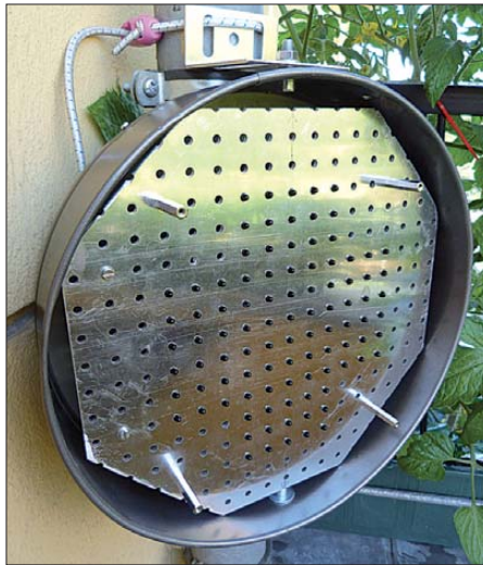
Bild 1: Als Gehäuse für die IR-Bake dient eine Kuchenbackform. Die Infrarot-LEDs sind in den erweiterten Bohrungen zweier übereinander liegender Lochbleche befestigt. Die Winkel oben und unten ermöglichen das Drehen und Kippen.
