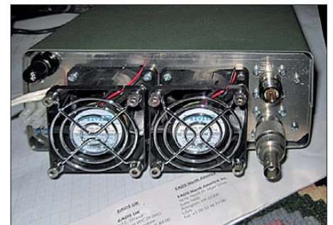
Bild 4: Zwei kräftige Ventilatoren bewirken die nötige Kühlluftzufuhr.
