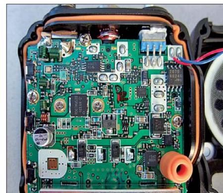
Bild 8: Blick ins Innere; gut zu erkennen liegt zwischen zwei Schraubenköpfen der Endstufentransistor. Das Röhrrchen rechts dichtet die Mikrofonkapsel ab. Fotos: DG1NEJ
