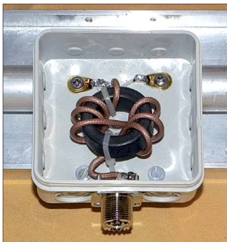
Bild 6: Praktische Ausführung des Baluns mit RG188 und einem FT140-43
