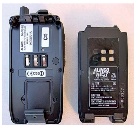
Bild 6: Der flache Lilon-Akkumulator EBP-63 mit 1,1 Ah Kapazität nimmt die gesamte Rückwand ein.
