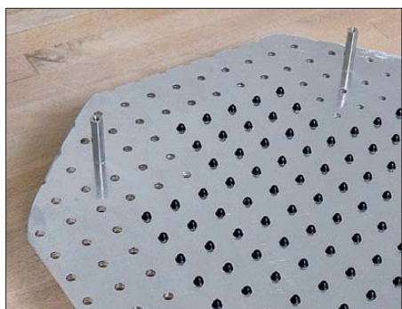
Bild 2: Die IREDs werden durch die beiden verschraubten Lochbleche mit unterschiedlichen Bohrdurchmessern gesteckt, wodurch sie schon nahezu fest sitzen.
