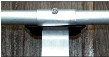
Bild 11: Die Reflektorbefestigung auf einem Vierkantboom kann mittels Polyamidhaltern erfolgen [5].
