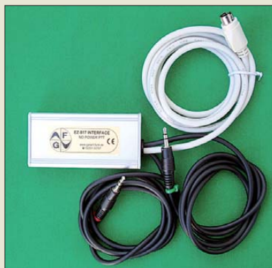
Das Soundkarten-Interface EZ-817 bezieht die für den Betrieb notwendige Energie über die Data-Buchse aus dem Transceiver.
