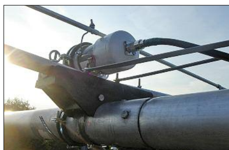
Bild 7: Die Boombefestigung bildet einen möglichen Schwachpunkt – vor dem Kauf unbedingt auf Materialermüdung prüfen!
