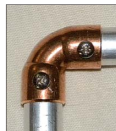
Bild 7: Die Ecken werden mit 12-mm-Kupfer-Fittings ausgeführt.
