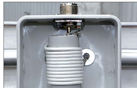
Bild 8: Alternative Kabeldrossel bis 250 W aus RG188
