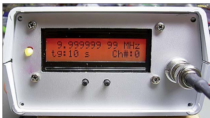
Bild 1: Der Reziprokkähler eignet sich sehr gut zur Frequenzmessung an Baugruppen, bei denen es auf hohe Genauigkeiten ankommt. Die letzte Stelle der Anzeige entspricht 10 mHz.
