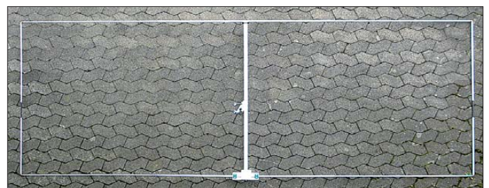
Bild 13: Fertig aufgebaute 12-m-Moxon
