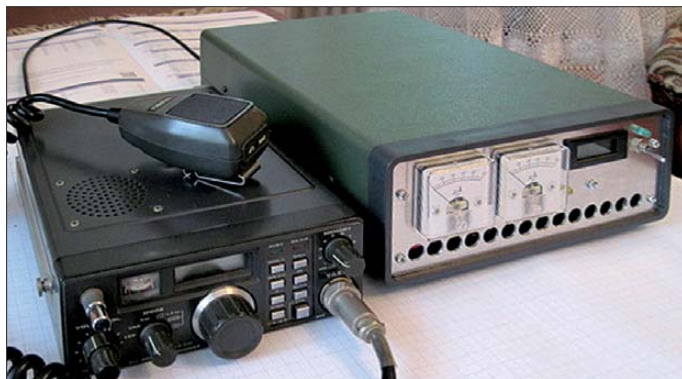
Bild 1: Versuchsmuster der 750-W-Endstufe, hier neben einem Yaesu FT-290R als Steuergerät, welches jedoch für Vollaussteuerung noch zu wenig Sendeleistung liefert Fotos: DJ1EE
