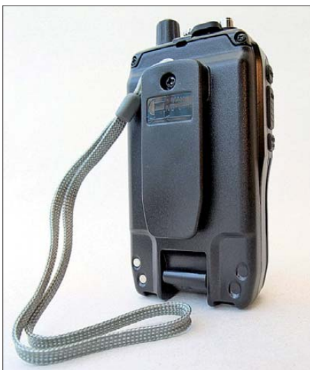
Bild 7: Am Akkumulator wird der Gürtelclip montiert und wahlweise an diesem oder direkt am Gerät die Handschleufe.
