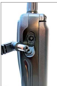
Bild 5: Auch die etwas größer als üblich dimensionierte Stromversorgungsbuchse verschwindet unter einer massiven Dichtung.
