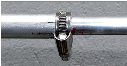
Bild 12: Die äußeren Stücke von Strahler und Reflektor lassen sich zum Abgleich verschieben und mit Schlauchschellen fixieren.
