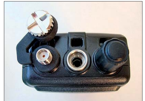
Bild 3: Umlaufende Gummidichtungen und die bei Nichtbenutzung massiv verschlossene vierpolige Klinkenbuchse schützen das Innenleben vor Staub und Wasser.
