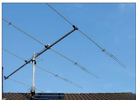
Bild 1: Restaurierte Antenne KT34A auf dem Dach bei DJ7ZZ in 12 m Höhe; an den Elementenden das Linear-Loading-System
