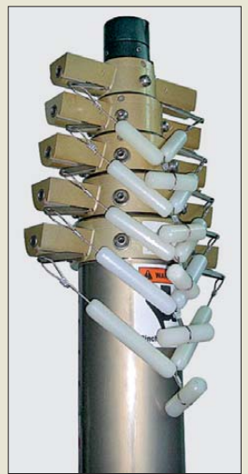
Die Ventile an jedem Segment der Teleskopmaste lassen sich beim Absenken schrittweise per Hand öffnen.
